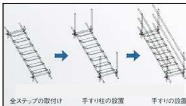
昇降階段の手摺・階段の間に隙間があるため、足を踏み外す（墜落する）おそれがある。作業員の安全確保（階段からの墜落防止）のため、隙間を設けない工夫として手摺を内側に設置する。（従来は、右上図のように手摺は手摺柱の内側に設置する。）
