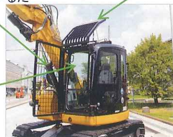
運転室周りの飛来物防護設備の例
